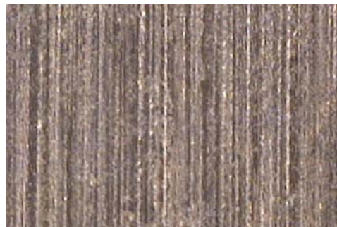
【Fig-03 Airy Touchのガスを供給して研削したタンゲステン銅】 きれいな加工面を見せている。
