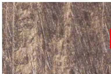
水溶性研磨剤供給によるタングステン銅の研磨
